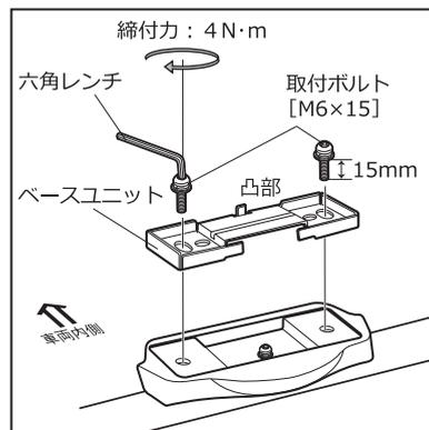
取付けたベースブラケットの上にキャリア本体付属のベースユニットを置き、取付ボルト [M6x15]を交互に固くなるまで締付ける。この時、ベースユニットの向きに注意してください。
